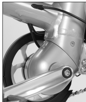
Aandrijffunit met ingebouwde trapkracht- en rotatiesensor
